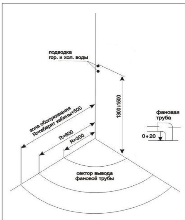
1. Подвод горячей и холодной воды – труба с наружной резьбой 1/2", высота над уровнем пола – 1300-1500 мм. Давление воды в водопроводе не менее 2-х атмосфер, но не более 4-х атмосфер.
